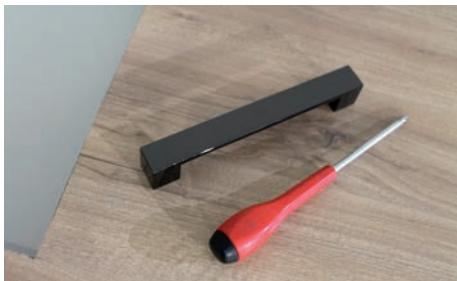
Zum Anbringen der Griffe wird ein Kreuzschlitz-Schraubendreher verwendet. Bitte benutzen Sie keinen Akkuschrauber, weil die Gewinde sonst überdreht oder zu fest angezogen werden könnten.
