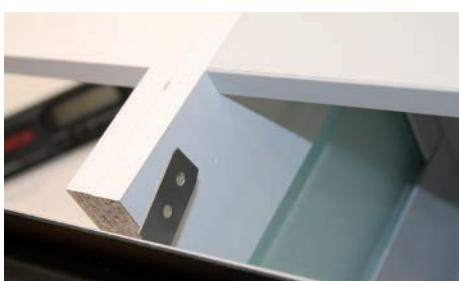
Die Verschraubungswinkel werden an den entsprechenden Stellen positioniert.
