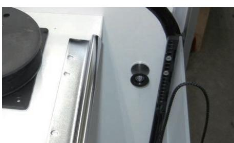
Si le rideau de meuble s'ouvre ou se ferme avec difficulté, les causes peuvent être les suivantes: le câble de traction fixé au rideau de meuble et à la poulie ne repose pas correctement sur le rouleau de guidage, dans la glissière du rideau de meuble, il existe peut-être une vis qu'il faut dans ce cas retirer, comme d'ailleurs tous les autres corps étrangers situés dans la partie arrière du passage du meuble à rideau.
