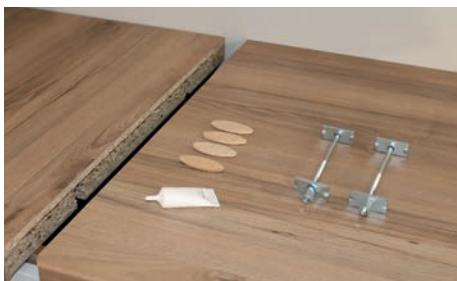
Um die einzelnen Arbeitsplatten im Winkel zu verbinden, benötigen Sie die abgebildeten Artikel (Arbeitsplatteneckverbinder, Flachdübel, Leimtube). Diese finden Sie im Zubehörpaket.
