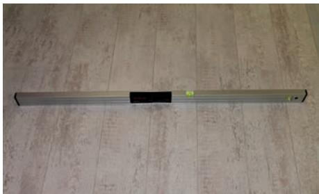
Prüfen Sie mit einer Wasserwaage wo sich der tiefste und der höchste Punkt im Raum befindet und beginnen Sie dementsprechend mit der Ausrichtung der Küchenmöbel. Beachten Sie dabei den Einstellbereich der Sockelfüße (siehe Hinweis auf Seite 7) sowie vorgegebene Einbauhöhen von integrierten Elektrogeräten.
