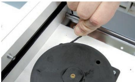
Tendez la poulie de telle sorte que la jalousie de se ferme pas sous l'effet de son propre poids et que l'on ne doive pas fermer la jalousie en forçant. Effectuez ces réglages de tension optimale en procédant par petites étapes. Les réglages diffèrent, en fonction de la longueur et de la largeur de la jalousie.
