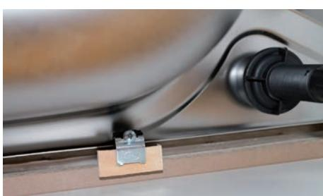
Attention pour plans de travail de 25 mm! En fonction des pinces de montage de l'évier, il faut utiliser lors du vissage la baguette de montage livrée en même temps.
