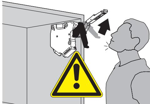
Verletzungsgefahr durch hochspringenden Hebel!
