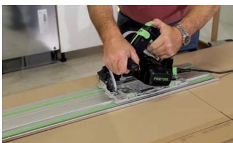
Die geraden Seiten können mit einer (Tauch-)Säge, evtl. auch mit einer Stichsäge ausgeschnitten werden.
